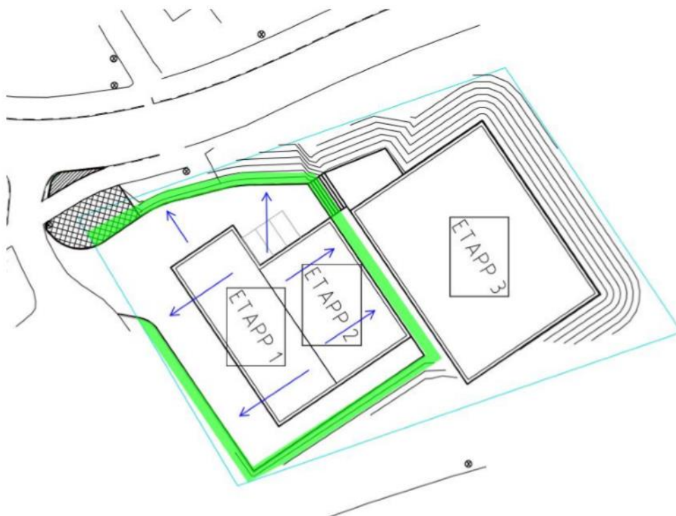
Förslag till systemlösning med placering av svackdike med slänt i grönt och flödespilar i blått.
